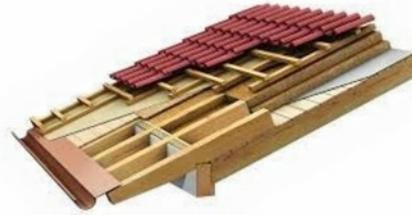
Imm.01 - Spaccato tipo di tetto legno lamellare isolato e ventilato.
