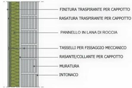
Imm.04- Sezione tipo di sistema di "Isolazione a cappotto con lana di roccia"
